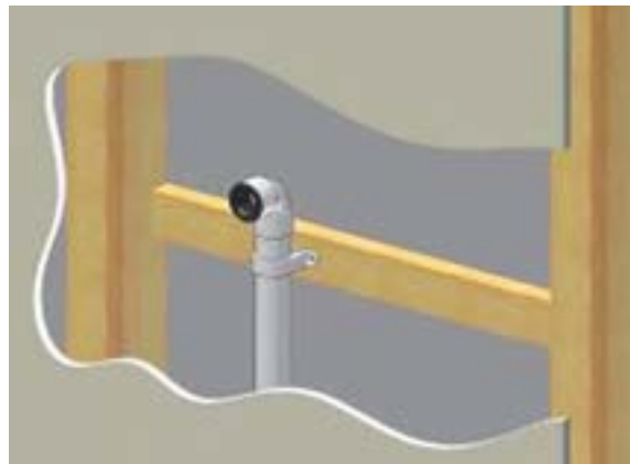
Obr. 15: Príprava pripojenia odvodu kondenzátu na zvislý odpad
