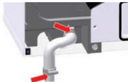
Obr. 11: Montáž hadice na kondenzát (zadná strana)
