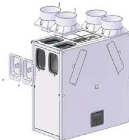
Obr. 18: Demontáž a inštalácia hrdiel
