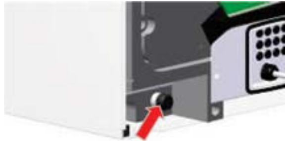
Obr. 9: Záslepka vývodu kondenzátu (zadná strana)
