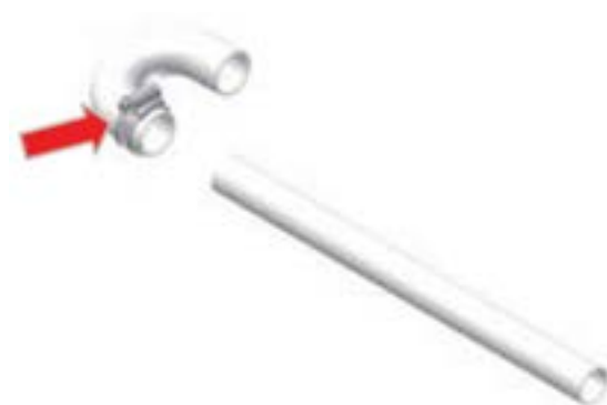
Obr. 16: Montáž hadice na kondenzát v tvare U
