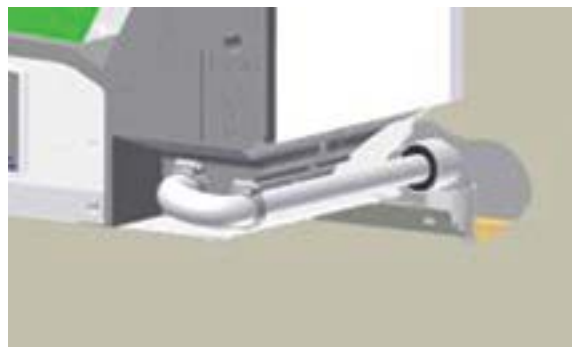
Obr. 17: Pripojenie rúrky 22 mm na odpad
