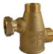
Termostatický ventil s automatickým vyvažovaním bypassu, s vonkajšími 1" závitmi na vstupe A a B a prevlečnou maticou 1" F na výstupe AB. Prevlečná matica umožňuje priame pripojenie obejového čerpadla s 1" pripojovacím závitom.
