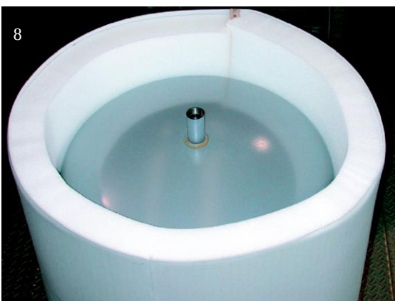
Obrázky znázorňujú postup montáže izolácie z mäkkej peny s PVC fóliou na nádrž.
