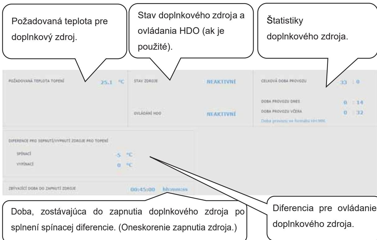
Aby nedochádzalo k zbytočným zapnutiam doplnkového zdroja a tým aj zvýšeným výdajom za elektrickú energiu, musí byť pre zapnutie doplnkového zdroja splnené určité podmienky.
