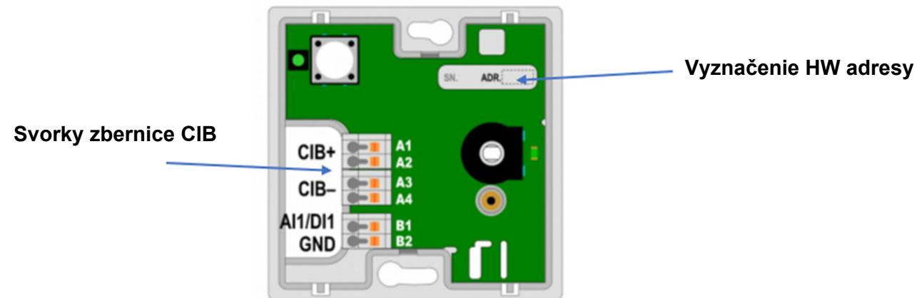
Odporúčame použiť kábel s krúteným tieneným párom a priemerom žíl najlepšie 0,8 mm (napr. J-Y(St)Y 1x2x0,8).
