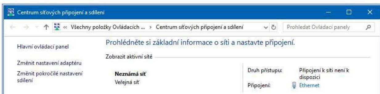
1. Kliknúť na **Ethernet** – otvorí sa okno so stavom pripojenie.
