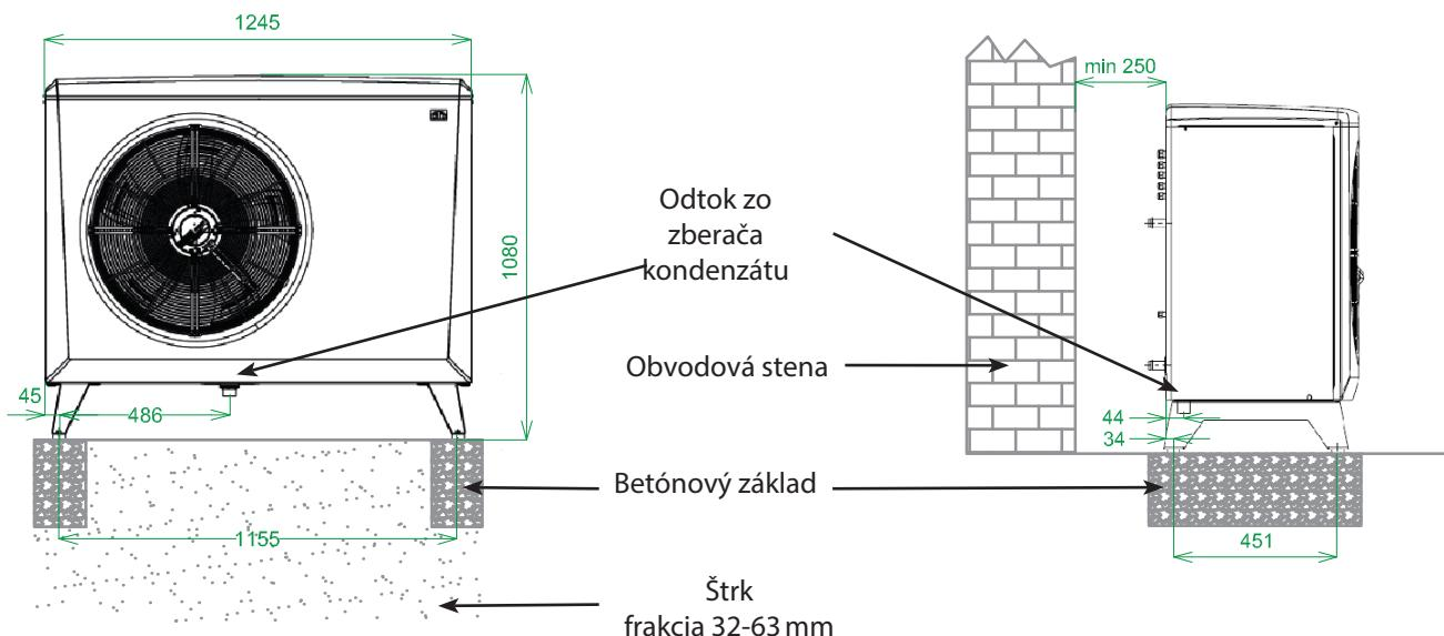
Tepelné čerpadlo je vybavené **zberačom kondenzátu** s odtokom (šrúbenie G 5/4" M je súčasťou dodávky - v príbale), z ktorého vyteká až 50 l vody za deň. Zberač je vybavený elektrickým vykurovacím káblom, ktorý ho chráni proti zamrznutiu. Odporúčame na vývod kondenzátu napojiť odtokové potrubie a kondenzát do neho odviešť. Odtokovú rúrkou je možné viest:
