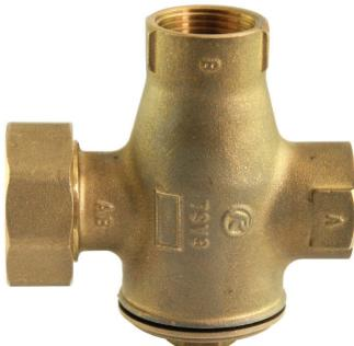
Termostatický zmiešavací ventil **TSV B** má zabudovanú termostatickú vložku, ktorá zatvára vstup „**A**“ (z vykurovacieho systému), ak je vratná voda do kotla (výstup „**AB**“) nižšia ako menovitá.
