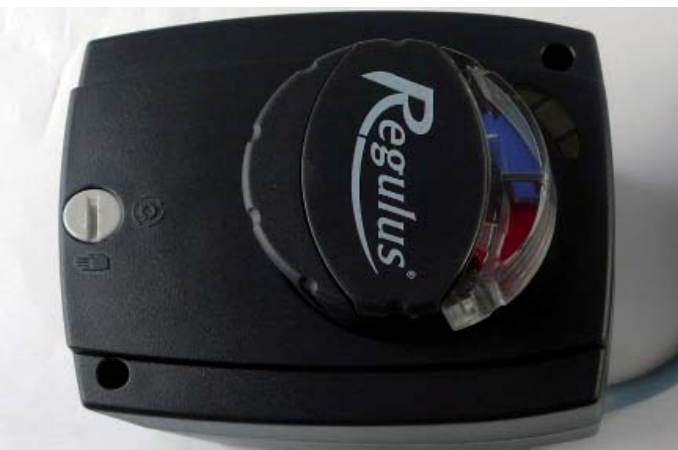
31. Prepnúť na ručné ovládanie a gombík nastaviť do polohy medzi červené a modré pole.
