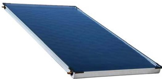
Plochý kolektor s výkonom 1866 W (pri osvite 1000 W/m<sup>2</sup>) určený k vertikálnej (na stojato) aj horizontálnej (na ležato) montáži nad strešnú krytinu. Lyrový absorbér s vysoko selektívnym povrhom TiNOx je spojený s medeným potrubím technológiou laserového zvárania. Izoláciu tvorí 40mm vrstva minerálnej vlny. Pripojenie je umiestnené hore a dole po stranách.
