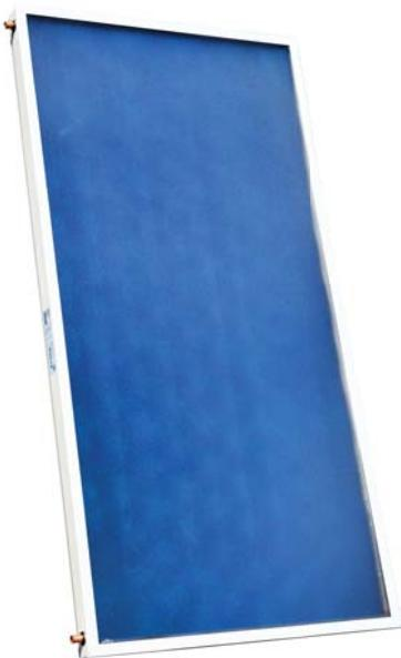
Plochý kolektor s výkonom 1481 W (pri osvite 1000 W/m<sup>2</sup>) určený k vertikálnej montáži (na stojato) nad strešnú krytinu. Lyrový absorbér s vysoko selektívnym povrhom TiNOx je spojený s medeným potrubím technológiou laserového zvárania. Izoláciu tvorí 40mm vrstva minerálnej vlny. Pripojenie je umiestnené hore a dole po stranách.
