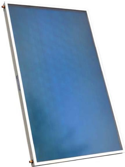
Plochý kolektor s výkonom 1802 W (pri osvite 1000 W/m<sup>2</sup>) určený k vertikálnej montáži (na stojato) nad strešnú krytinu. Lyrový absorbér s vysoko selektívnym povrchom TiNOx je spojený s medeným potrubím technológiou laserového zvárania. Izoláciu tvorí 40mm vrstva minerálnej vlny. Pripojenie je umiestnené hore a dole po stranách.
