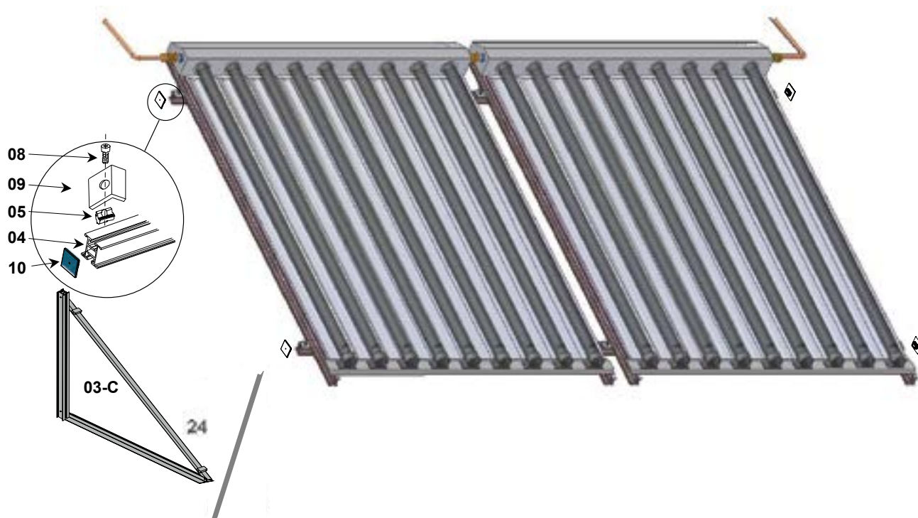
Obr. 15: Trojuholníková podpera a zavetrovací vzpera
