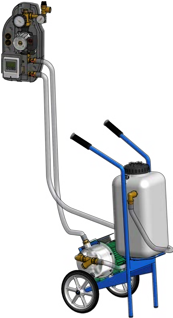
Obr. 32: Plnenie solárneho systému
