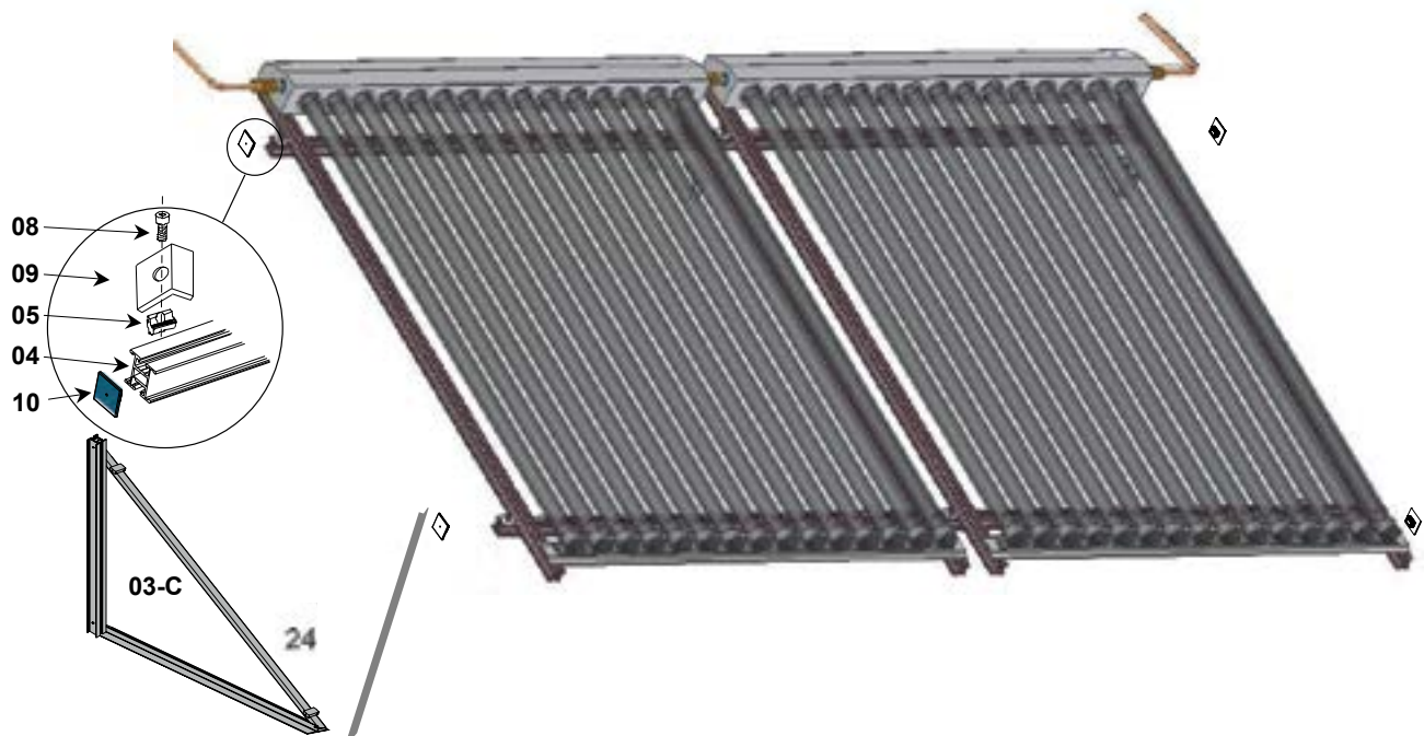
Obr. 15: Trojuholníková podpera a zavetrovací vzpera
