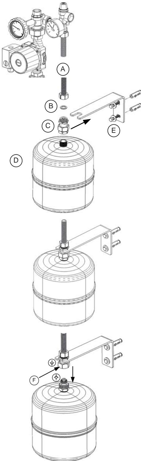
(A) 3/4" ohybná rúrka pre pripojenie k poistnému ventilu čerpadlovej skupiny (nie je súčasťou dodávky).
