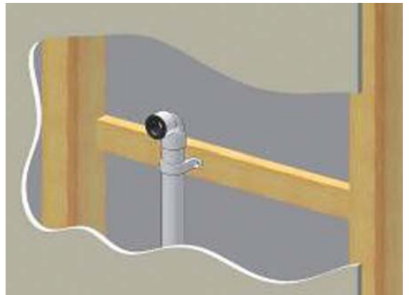
Obr. 15: Príprava pripojenia odvodu kondenzátu na zvislý odpad
