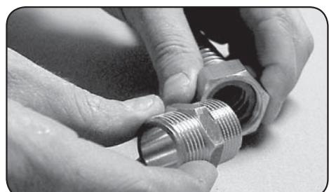
Do prevlečnej matice zaskrutkujte vhodné šrúbenie (napr. šrúbenie s vonkajším závitom alebo šrúbenie so zverným spojom).
